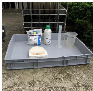
Kunststoffbox als mobiler Befüll- und Waschplatz z. B. für Sprühflaschen
