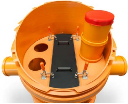
Chambre HydroClean Pro DN 1000 avec paroi adsorbant au millieu de 30 cm avec PURAT et charbon activ
