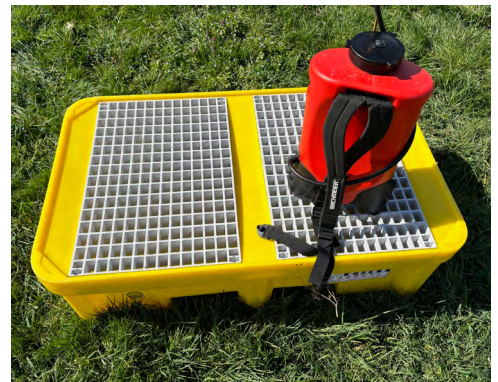
Station de remplissage et de lavage mobile
