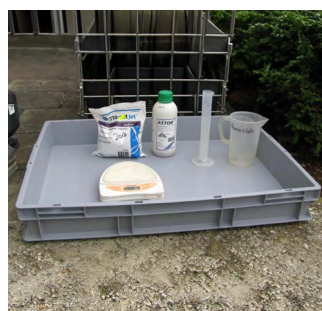
Bac en plastique servant de station de remplissage et de lavage mobile, par exemple pour les pulvérisateurs manuels
