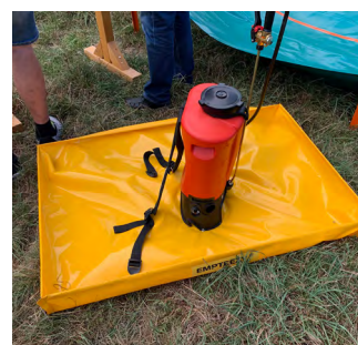
Bâche mobile avec bord relevé pour le remplissage de pulvérisateurs et atomiseurs de petite taille
