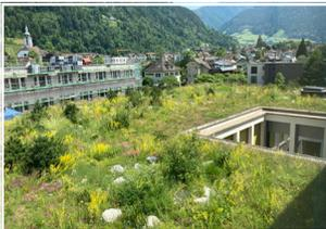
**Bemerkungen:** Das kritische Element bei Gründächern und Fassaden ist die Wahl der Art des Rückhaltebauwerks. Bevorzugen Sie eine Retention im Substrat anstelle von künstlichen Volumina, wobei bei letzteren ein oberirdischer Kontakt mit der Aussenwelt vermieden werden sollte (Achtung Notüberlauf).
