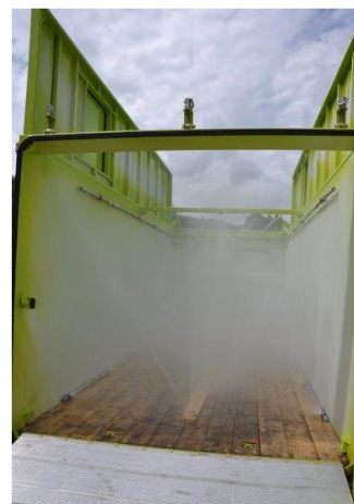
Figura 1: Container di spegnimento
